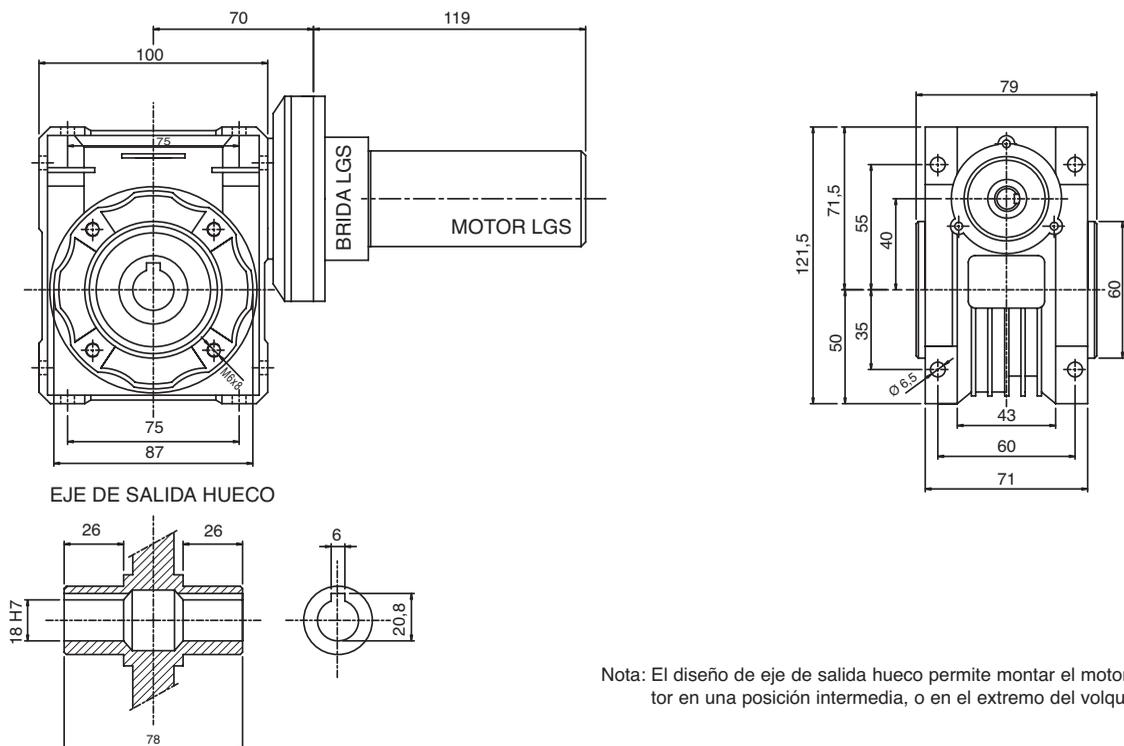
Nota: El diseño de eje de salida hueco permite montar el motorreductor en una posición intermedia, o en el extremo del volquete.
