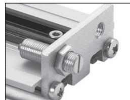
**Ejemplo: "Slita" de Ø 16 mm (cilindro ISO 6432) y recorrido 160 mm., con amortiguadores hidráulicos sobre el flanco.**
