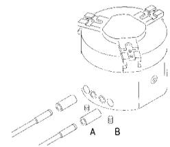
**Fluido:** Aire comprimido, filtrado, lubricado o no lubricado
