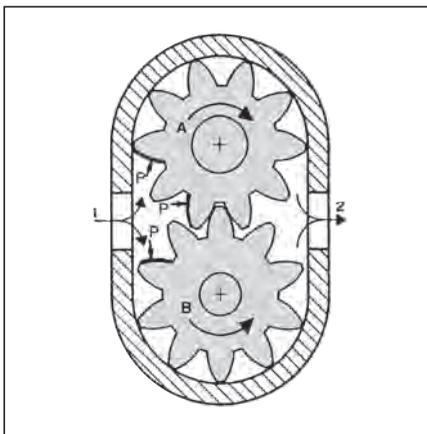
La estanqueidad interna, que es esencial para el mantenimiento de las prestaciones se obtiene, simple y eficazmente, no solamente por la gran precisión con la que están fabricadas las piezas sino además, por un ajuste meticuloso que se hace de una vez por todas en el montaje en fábrica; los dos rotores ruedan, uno sobre otro, sin contacto.
