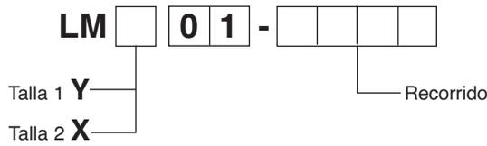
La referencia comprende el perfil en aluminio extrusionado ensamblado con la barra de acero templado y un carro completo, con la protección de plástico rojo, montado sobre la guía lineal.
