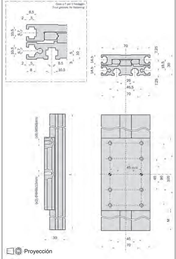
El carro está recabado de un perfil de aluminio estrusionado en el cual están previstas las sendas para los cartuchos de recirculación de bolas y las ranuras en T para diversas fijaciones. La particular forma permite el juego adecuado y el reglaje de la precarga a través de cuatro tornillos.
