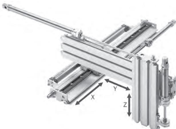
Manipulador de dos ejes, tipo Pick & Place. El carro del eje Z está unido al raíl del eje Y, con el kit LZK - 013 - 2
