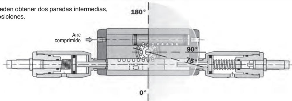
La posición externa del final del recorrido puede ser regulada ( $0^\circ + / -5^\circ$  o  $180^\circ + / -5^\circ$ ) con los mismos accesorios del RT (amortiguadores hidráulicos, amortiguadores de goma, pernos).
