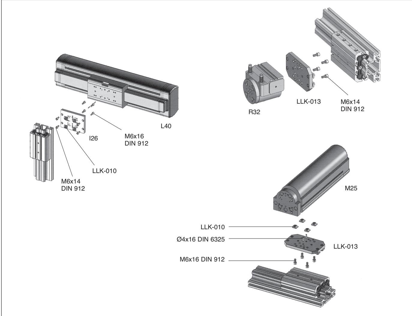
Diagrama de ensamblaje con otros componentes GIMATIC:
