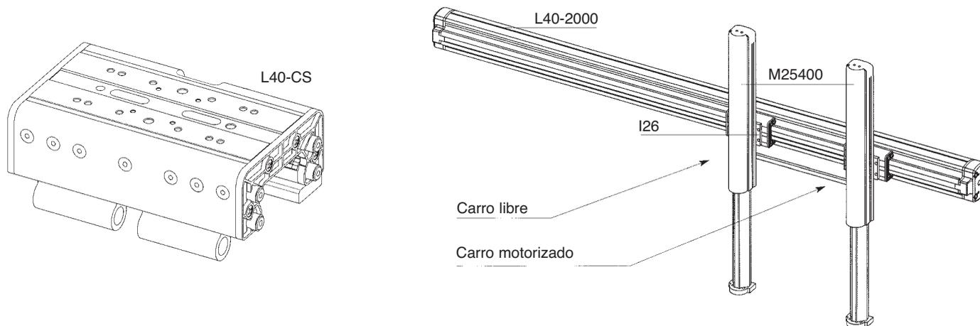
El segundo carro, puede ser accionado independiente del carro principal, por un cilindro neumático ISO Ø 25 mm. y alojado sobre el cuerpo lateral (alternativamente a la cadena portacables). Gimatic suministra el Kit de montaje del cilindro (Ref. LS-CL).
