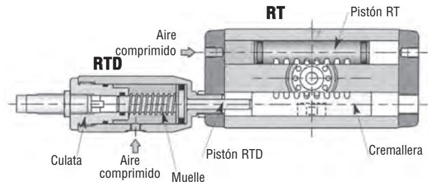
El recorrido del RTD puede ser fácilmente regulado mediante distancias enfrentadas del pistón, obteniendo de este modo paradas intermedias en diversas posiciones.
