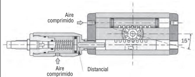
Utilizando dos RTD se pueden obtener dos paradas intermedias, para un total de cuatro posiciones.
