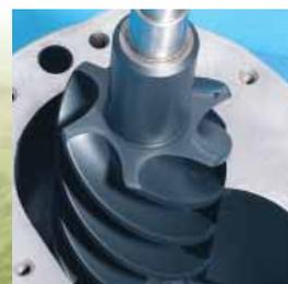
Rotores y carcasas revestidos para una máxima protección y una larga vida útil
