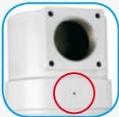
**Señalización acústica** – Un orificio practicado en la testa del filtro advierte al utilizador cuando el cuerpo no ha sido suficientemente bien sujeto en la sustitución del elemento, o cuando se esta desmontando el filtro y aun esta bajo presión.
